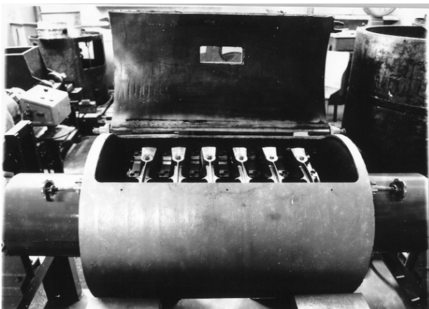
Рис. 1. Вібраційна машина з обертовим пристроєм для обробки деталей у закріпленому стані та її розрахункова схема
