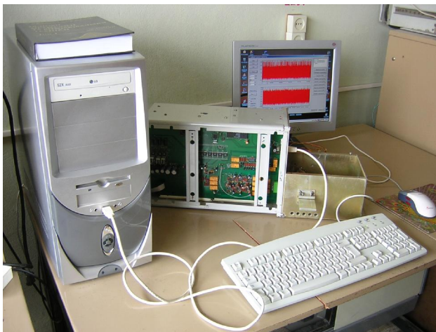
Рис. 1. Устава для дослідження шумових процесів у первинних перетворювачах для шумових термометрів. (Загальний вигляд)
