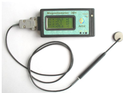
Рис. 8. Фотографія портативного 3-D магнітометра на основі кутового сенсора магнітного поля
