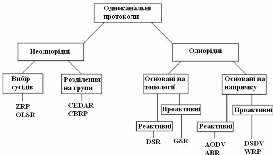
Рис. 8. Поділ протоколів в сенсорних мережах
