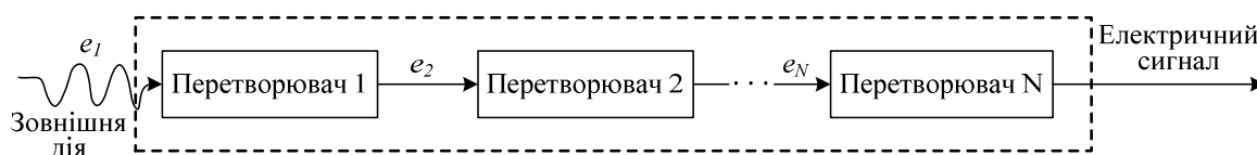
Рис. 1. Загальний вигляд складеного сенсора, що складається з N -перетворювачів: e_1 , e_2 , e_N – різні види енергії.
