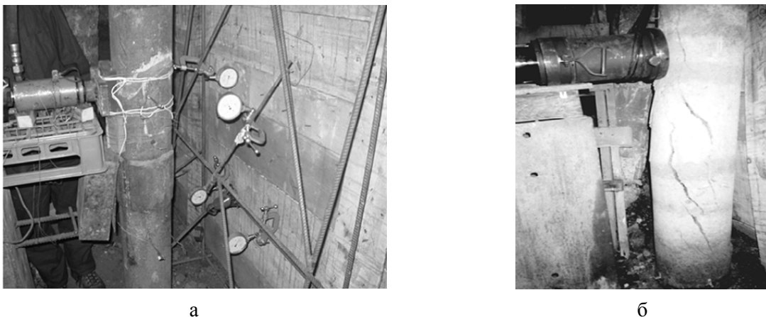
Рис. 4. Вигляд дослідної установки: а – загальний вигляд; б – характер руйнувань палі ПБ3
