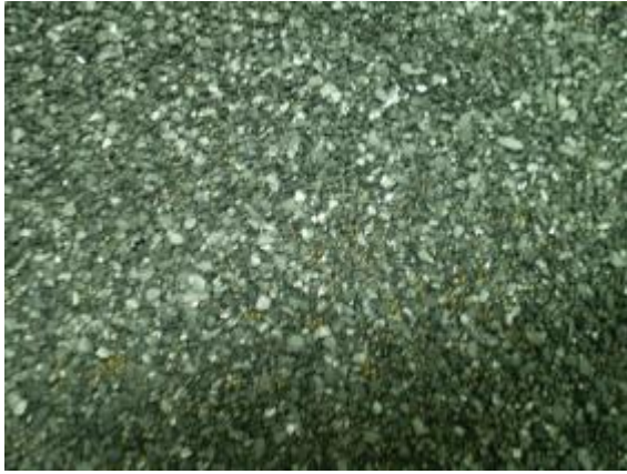
Рис. 2. Загальний вигляд завантаження картриджа побутового фільтра "Роса" (Україна)
