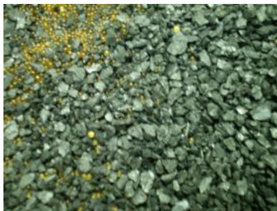
Рис. 6. Загальний вигляд завантаження картриджа побутового фільтра "ЗІКО-Ф3"
