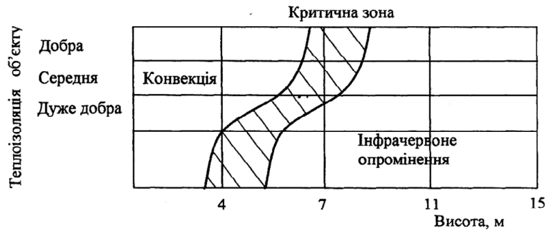
Рис. 1. Ефективність застосування конвективних та променевих систем опалення від висоти та якості теплоізоляції приміщення
