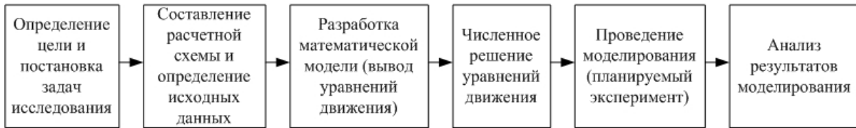
Рис. 19. Этапы проведения исследования кинематических и динамических процессов механических систем
