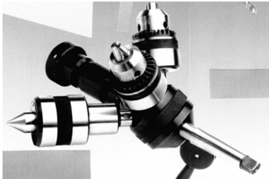
Рис. 3. Револьверні головки з індивідуальними приводами, встановлювані в піноль задньої бабки
