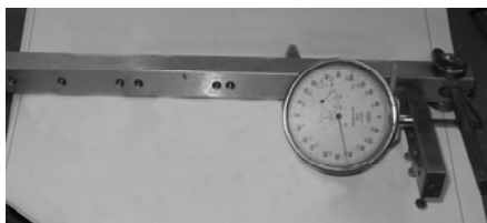
Рис. 4. Прилад для заміряння деформацій пінобетону: а – загальний вигляд компаратора; б – місця розміщення металевих маяків
