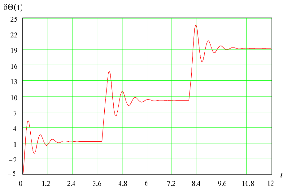
Рис. 2. Закон руху відхилення ротора КД від положення рівноваги при k_p = 0.5
