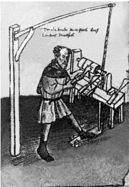
Рис. 1. Обточування дерев'яного вала на пристрої з ручним приводом (а) та полірування поверхні на верстаті з водяним приводом (б)
