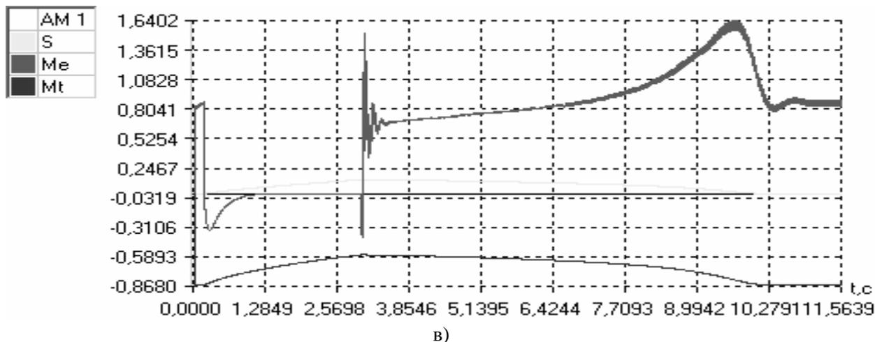
Рис. 2. (Продовження). Цифрограми симулювання самозапуску асинхронного двигуна потужністю 5 МВт власних потреб блока електричної станції:
