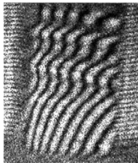
Рис. 6. Інтерференційні картини неякісних монокристалічних пластин із кристалів \text{LiNbO}_3:\text{MgO} (а) та зразків, вирізаних з цих пластин (б)
