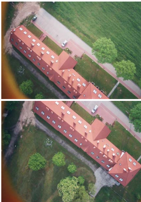
Ryc.1. Przykładowa, jedna z kilkudziesięciu par zdjęć niskopułapowych, realizowanych na terenie WIŚiG Uniwersytetu Rolniczego przy ul. Balickiej w Krakowie – opracowywane na FSC „DELTA”.
