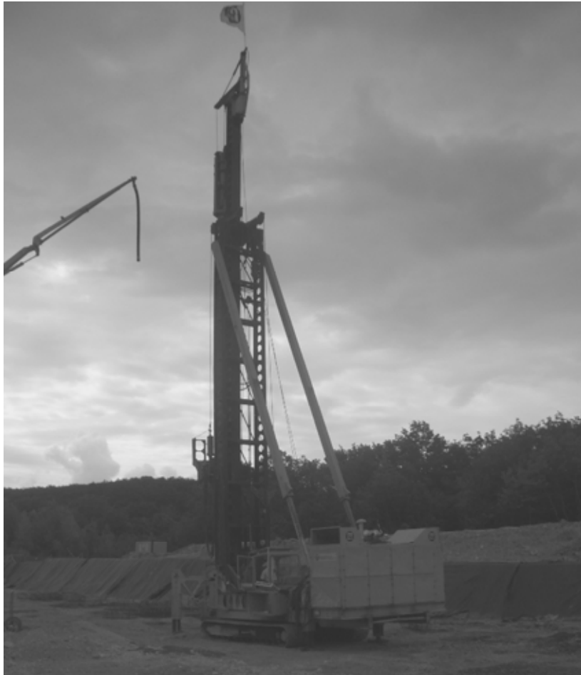
Рис. 1. Зовнішній вигляд установки типу “Kasagranda” для влаштування буронабивних паль
