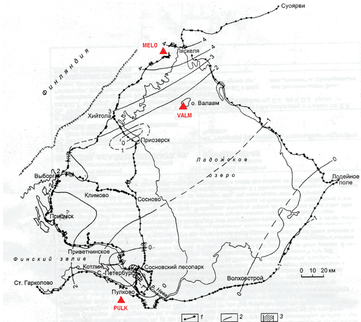
Рис. 2. Схема нивелирной сети и карта современных вертикальных движений земной поверхности Карельского перешейка: 1 — нивелирные линии и репера, 2 — изолинии скоростей и мм/год, 3 — зоны контрастных движений (Энман, 2006). Красными треугольниками показаны GPS пункты
