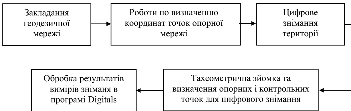
Рис.3 Технологічна блок-схема складання великомасштабних планів наземним цифровим стереофотограмметричним методом
