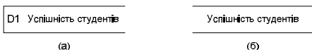
Рис. 4.19. Позначення накопичувача даних на DFD в нотаціях Гейна-Сарсона (а) та Йордана (б)
