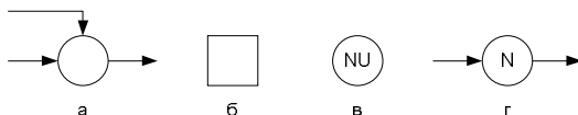
Рис. 4.21. Додаткові елементи керування потоками даних на DFD: а – груповий вузол; б – вузол-батько; в – вузол, що не використовується; г – вузол зміни імені
